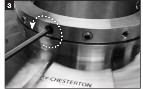
ロックリングからカップポイントスクリューとドッグポイントセットスクリューをすべて外し、廃棄します。
