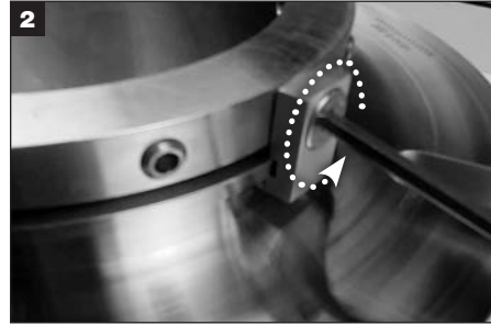
センタリングクリップを外し、廃棄します。
